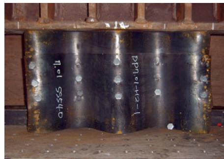
(b) t=7.01\text{mm} (SS540), bolt shearing
